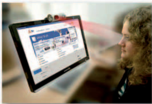
Rys. 4. Interfejs człowiek-komputer sterowany mrugnięciami
