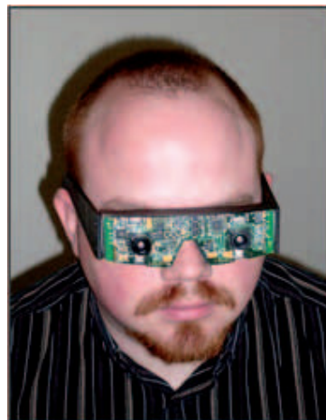
Rys. 7. Prototyp interfejsu „elektronicznych okularów” przetwarzających obrazy na dźwięki [39]
